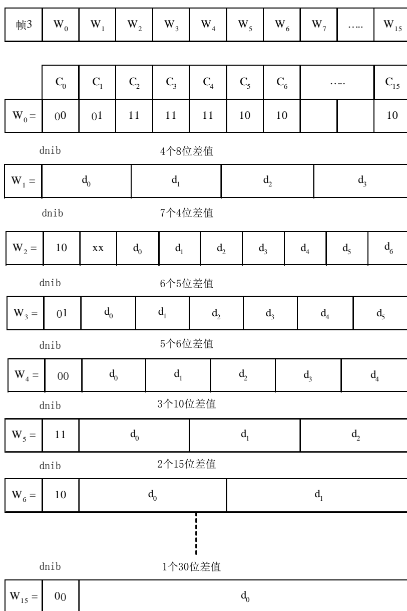
图 B.2 Steim2 压缩数据格式
